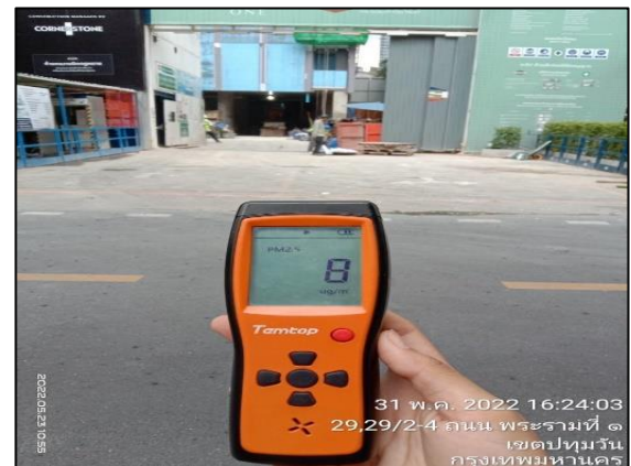
รูปที่ 2-7 เครื่องตรวจวัดปริมาณฝุ่นละออง
